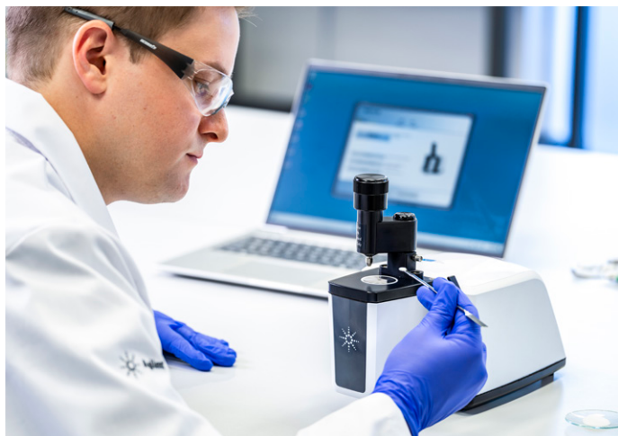
Figure 1. Il est possible d'équiper le spectromètre FTIR Agilent Cary 635 des modules d'échantillonnage adaptés afin de répondre à tous les besoins analytiques. Le module d'échantillonnage ATR à diamant est idéal pour l'analyse FTIR des solides, des liquides, des gels et des poudres.
