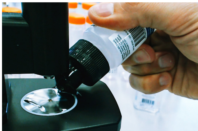
Figure 8. L'échantillon pur de désinfectant pour les mains est placé sur l'accessoire ATR. La suite logicielle MicroLab Agilent utilise des flux de travail guidé par des images pour aider les utilisateurs à suivre chacune des étapes de mesure, notamment le nettoyage et l'échantillonnage.
