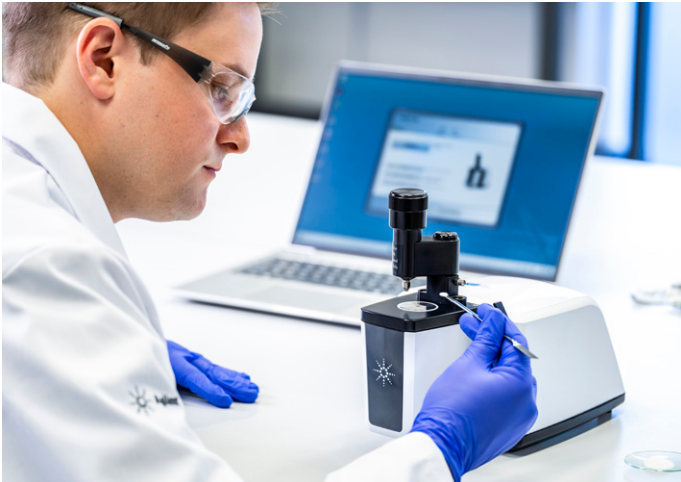
Abbildung 1. Das Agilent Cary 635 FTIR-Spektrometer kann mit den passenden Probenzubehörmodulen ausgerüstet werden, um alle analytischen Anforderungen zu erfüllen. Das Diamant-ATR-Modul ist ideal für die FTIR-Analyse von Feststoffen, Flüssigkeiten, Gelen und Pulvern.
