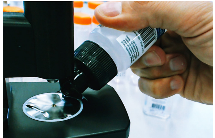
Abbildung 8. Das unverdünnte Handdesinfektionsmittel wird auf das ATR-Zubehör gegeben. Die Agilent MicroLab Software leitet den Anwender anhand bildgeführter Arbeitsabläufe Schritt für Schritt durch die Messung, Reinigung und Probenerfassung.
