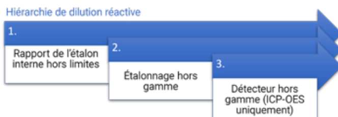
Figure 6. Processus de décision pour la dilution réactive des logiciels ICP Expert et ICP-MS MassHunter Agilent.
