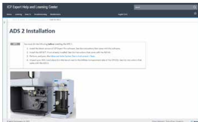
Figure 18. Les procédures d'installation, de fonctionnement, de maintenance et de résolution des anomalies de l'ADS 2 dans les pages du logiciel du centre d'aide et d'apprentissage intégré des logiciels ICP Expert et ICP-MS MassHunter.
