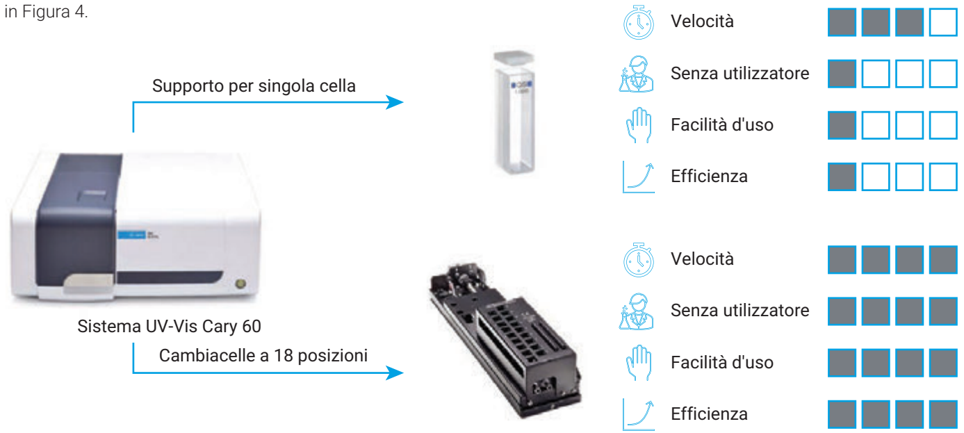
Figura 4. Valutazione dei flussi di lavoro con supporto per singola cella e con cambiaccelle a 18 posizioni Agilent in termini di velocità, intervento dell'utilizzatore, facilità d'uso ed efficienza.
