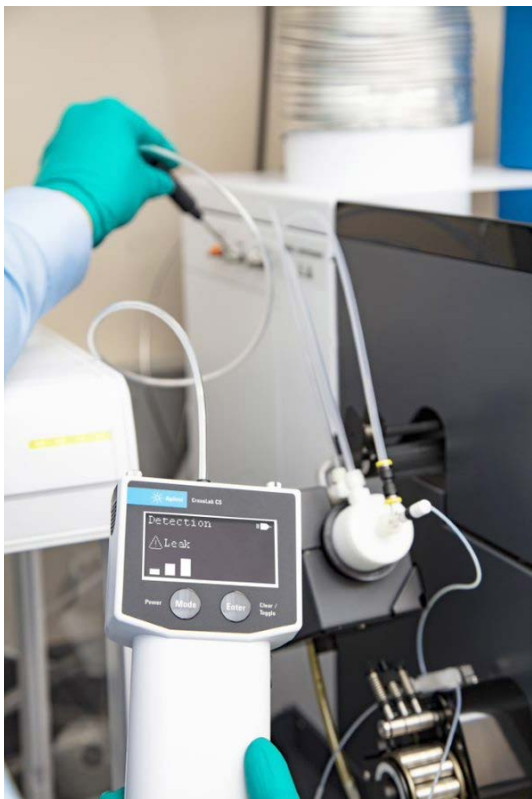
图 18. 使用 Agilent CrossLab CS 电子检漏仪检查 Agilent 7900 ICP-MS 的可选气体端口是否存在泄漏
