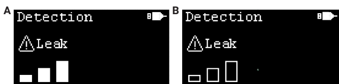
图 7. 热导率高于空气的气体泄漏 (A) 和热导率低于空气的气体泄漏示例 (B)
