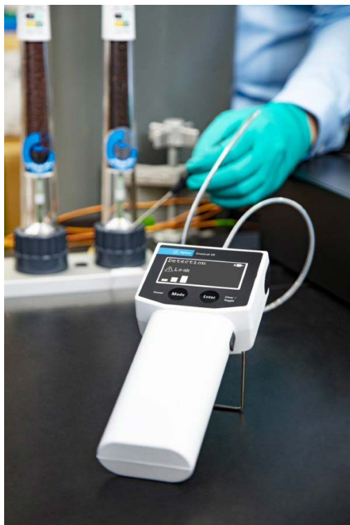
图 8. 使用 Agilent CrossLab CS 电子检漏仪检查 Gas Clean 气体净化过滤器装置是否存在泄漏的示例
