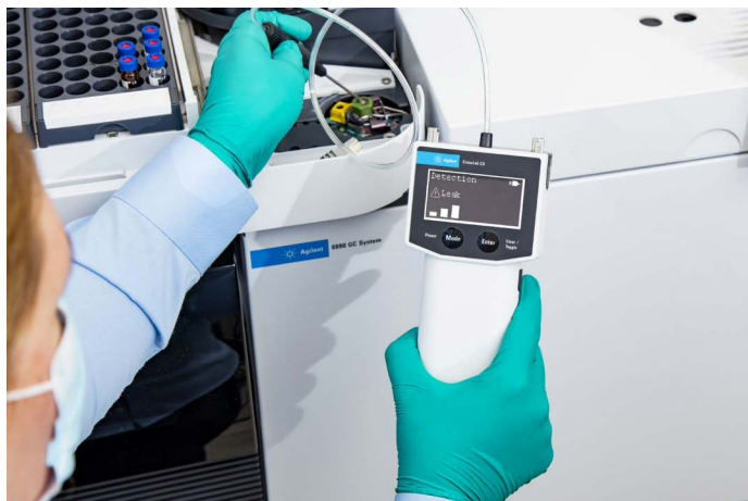
图 12. 使用 Agilent CrossLab CS 电子检漏仪检查气相色谱进样口隔垫螺帽是否存在泄漏
