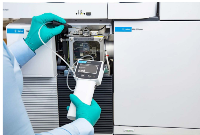
图 16. 检查 GC/MS 系统气相色谱柱温箱中的质谱仪传输线 (A) 和质谱仪上的放空阀 (B) 处是否存在泄漏
