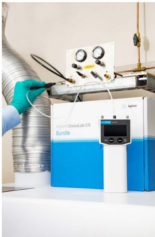
图 10. 使用 Agilent CrossLab CS 电子检漏仪检查氦气接头的示例
