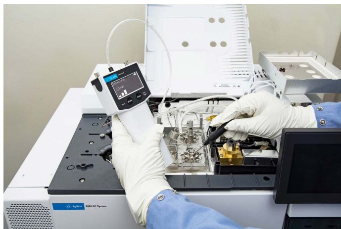
图 15. 使用 Agilent CrossLab CS 电子检漏仪检查带阀气相色谱系统中的连接点是否存在泄漏
