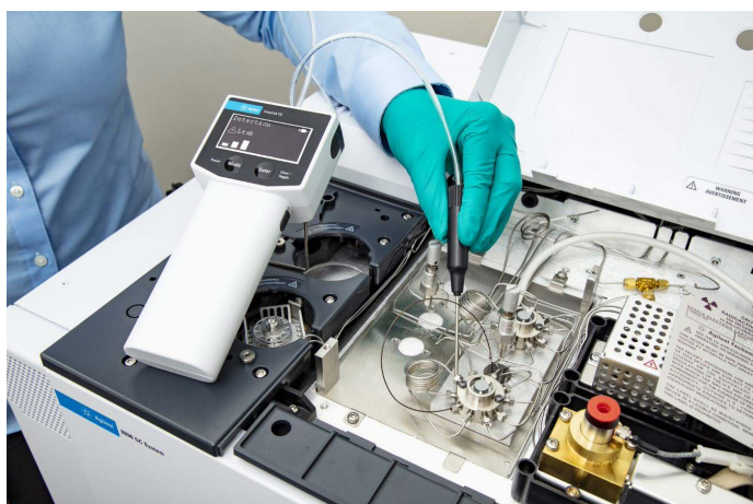
图 6. 使用 Agilent CrossLab CS 电子检漏仪检查阀系统是否存在泄漏的示例
