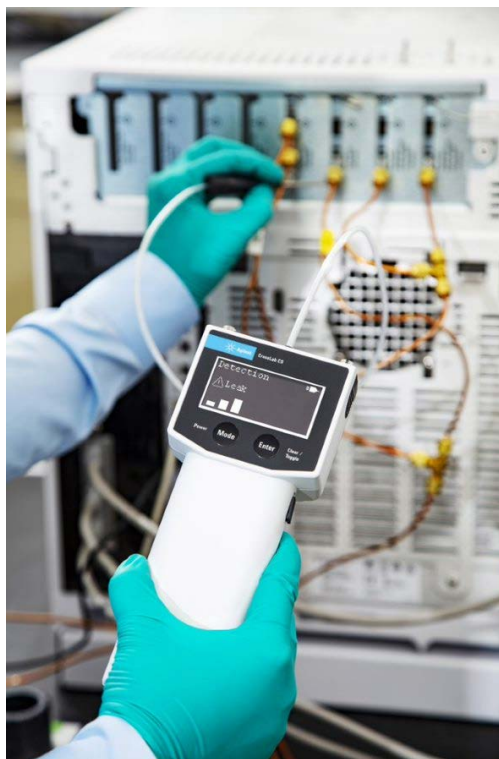
图 9. Agilent 8890 气相色谱仪背面气体接头的泄漏检查示例
