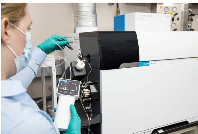
图 19. 检查 Agilent 7900 ICP-MS 的雾化器接头是否存在泄漏
