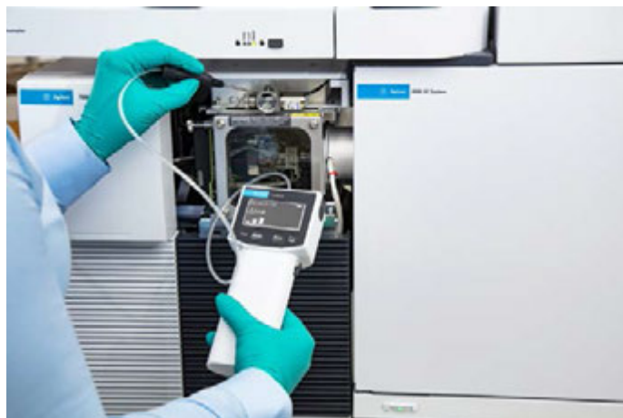
Рисунок 16. Проверка на утечки системы ГХ-МС на транспортной линии масс-спектрометра в термостате ГХ (А) и на клапане испарителя (В) масс-спектрометра.
