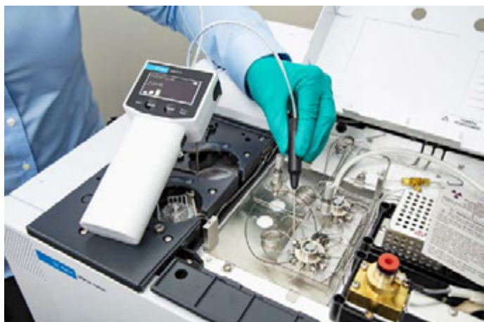
Рисунок 6. Пример проверки на наличие утечки системы быстрого переключения потоков с помощью электронного течеискателя Agilent CrossLab CS.
