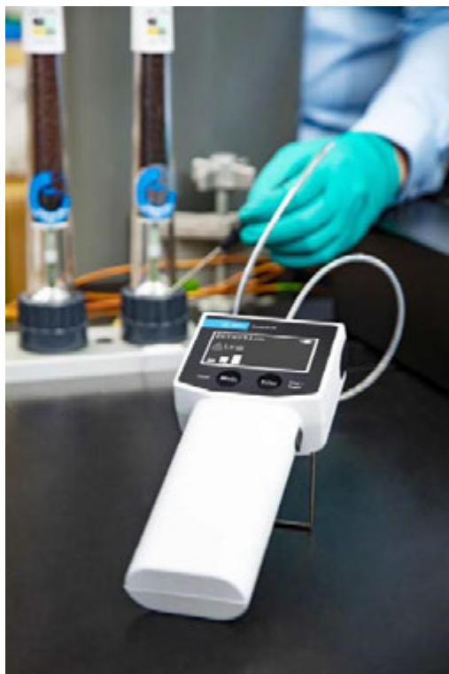
Рисунок 8. Пример проверки на наличие утечки системы фильтров для очистки газов с помощью электронного течеискателя Agilent CrossLab CS.
