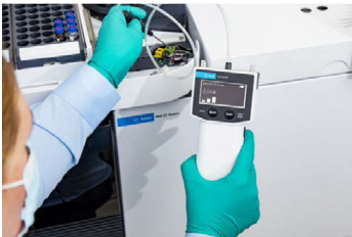
Рисунок 12. Проверка на наличие утечки гайки септы испарителя ГХ с помощью электронного течеискателя Agilent CrossLab CS.
