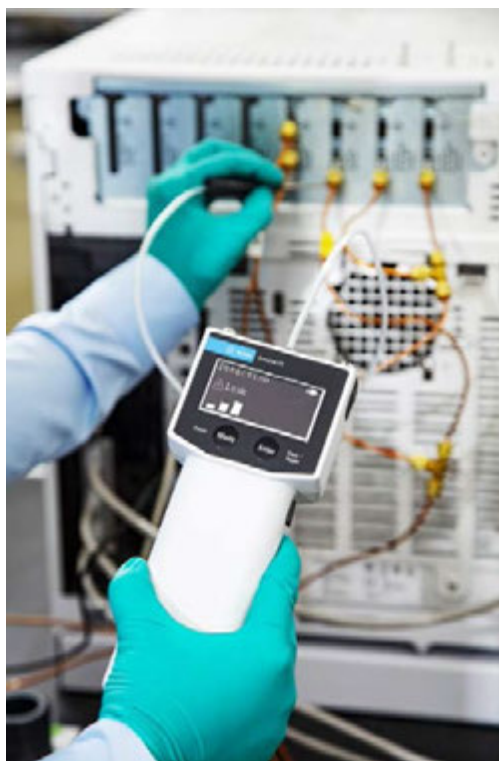
Рисунок 9. Пример проверки на утечки газовых фитингов на задней стороне ГХ Agilent 8890.
