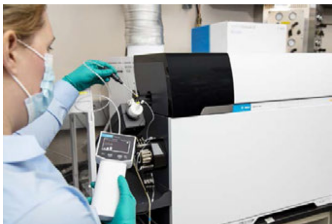
Рисунок 19. Проверка на наличие утечек на фитингах распылителя системы ИСП-МС Agilent 7900.
