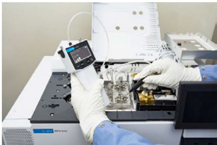
Рисунок 15. Применение электронного течеискателя Agilent CrossLab CS для проверки на наличие утечек в соединениях системы быстрого переключения потоков ГХ.
