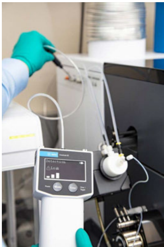
Рисунок 18. Применение электронного течеискателя Agilent CrossLab CS для проверки на наличие утечек в порте для дополнительного газа в системе ИСП-МС Agilent 7900.
