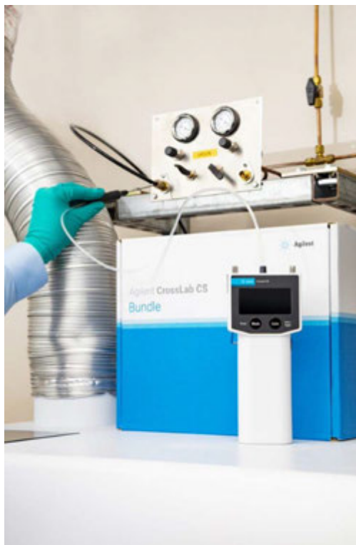
Рисунок 10. Пример использования электронного течеискателя Agilent CrossLab CS для проверки фитингов для аргона.
