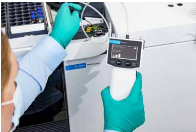
Figura 12. Verificação de vazamento na porca do septo do injetor do GC com o detector de vazamentos eletrônico CS Agilent CrossLab.
