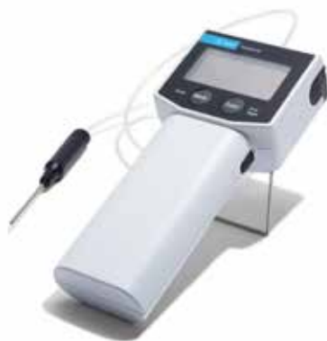
Figura 1. O detector de vazamentos eletrônico com sistema de cartucho (CS) Agilent CrossLab foi projetado para detectar vazamentos de gases não corrosivos, inclusive misturas de gases.
