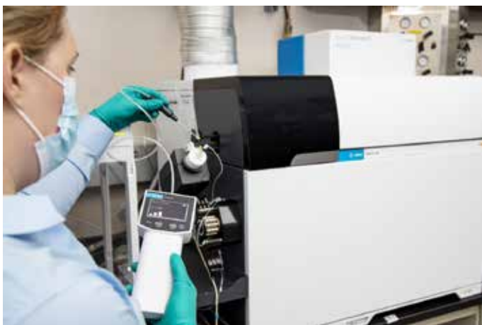
Figura 19. Verificação de vazamentos nas conexões do nebulizador do ICP-MS Agilent 7900.
