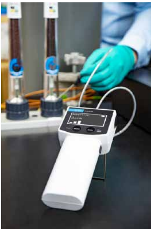
Figura 8. Exemplo de verificação de vazamento em uma unidade do filtro para limpeza da linha de gases com o detector de vazamentos eletrônico CS Agilent CrossLab.
