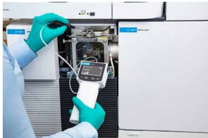
Figura 16. Verificação de vazamentos em um sistema de GC/MS na linha de transferência do espectrômetro de massa no forno do GC (A) e na válvula de quebra de vácuo (B) no espectrômetro de massas.
