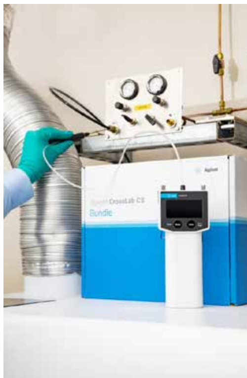
Figura 10. Exemplo de uso de um detector de vazamentos eletrônico CS Agilent CrossLab para verificar as conexões de gás argônio.
