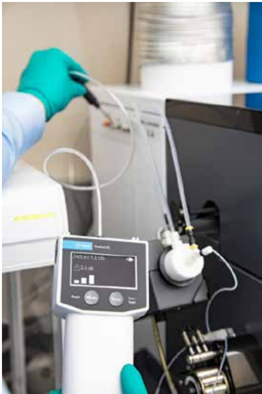
Figura 18. Uso do detector de vazamentos eletrônico CS Agilent CrossLab para verificar se há vazamentos na porta de gás opcional no ICP-MS Agilent 7900.
