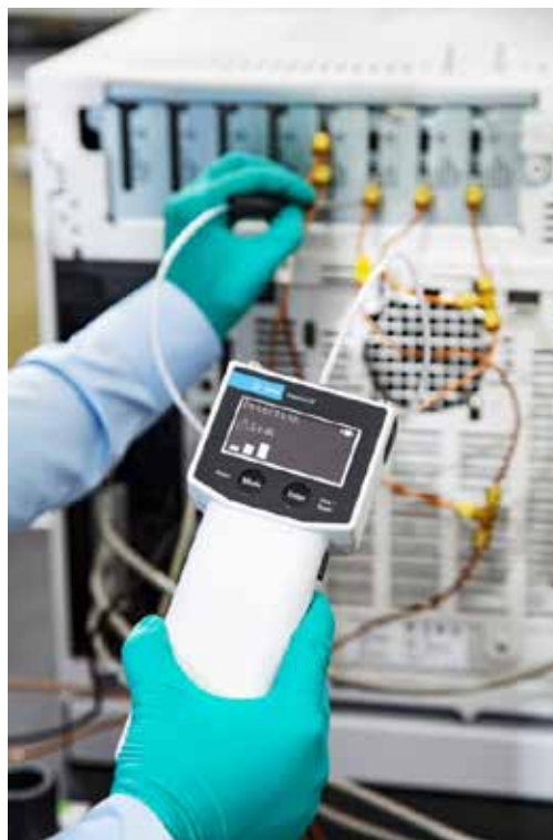
Figura 9. Exemplo de uma verificação de vazamento nas conexões de gás na parte traseira de um GC Agilent 8890.
