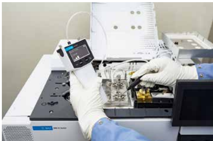
Figura 15. Uso do detector de vazamentos eletrônico CS Agilent CrossLab para verificação de vazamentos nas conexões de um sistema GC com válvulas.
