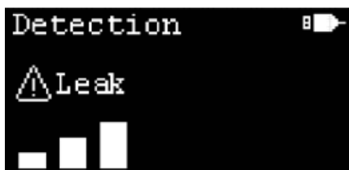
Figura 3. Esempio di individuazione di perdita sullo schermo OLED.
