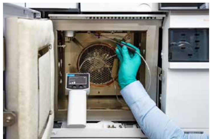
Figura 13. Verifica della presenza di perdite nell'iniettore di GC (A) e sulle connessioni del dispositivo Capillary Flow Technology (CFT) di Agilent (B).
