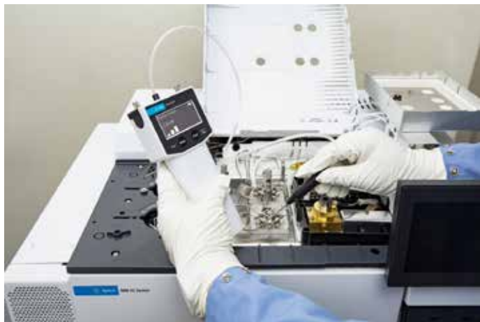
Figura 15. Utilizzo del rivelatore di perdite elettronico Agilent CrossLab CS per verificare la presenza di perdite in corrispondenza delle connessioni in un sistema GC dotato di valvole.
