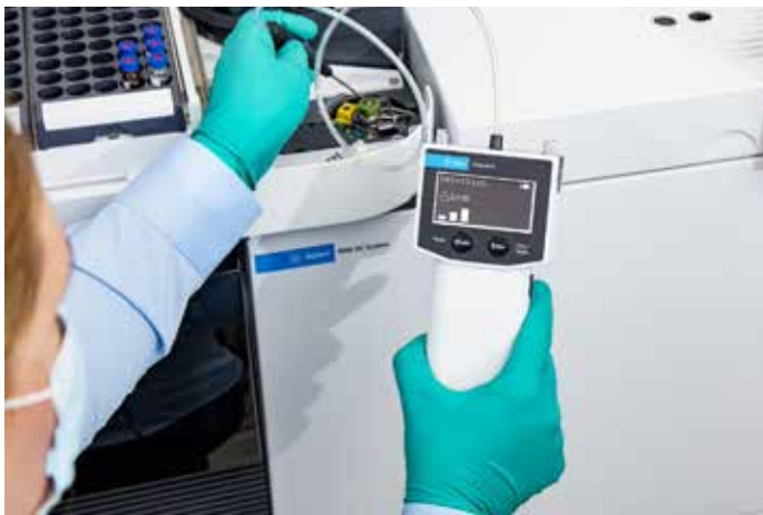
Figura 12. Verifica della presenza di perdite sul dado del setto dell'iniettore del GC con il rivelatore di perdite elettronico Agilent CrossLab CS.
