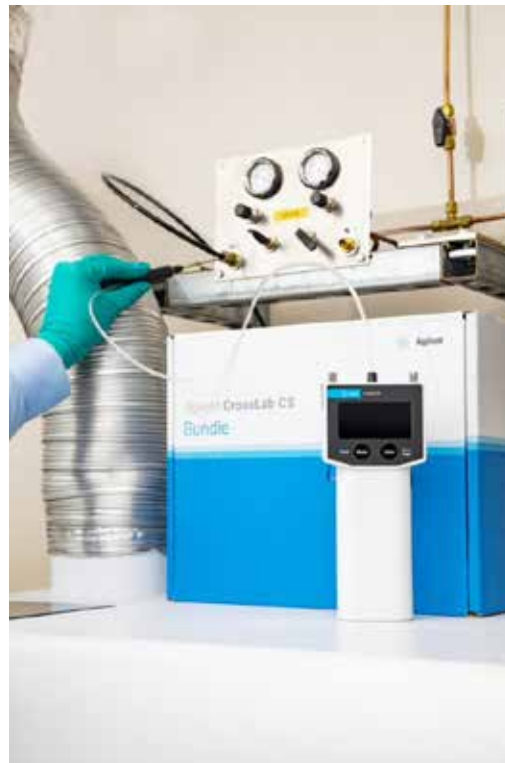
Figura 10. Esempio di uso del rivelatore di perdite elettronico Agilent CrossLab CS per verificare i raccordi per gas argon.
