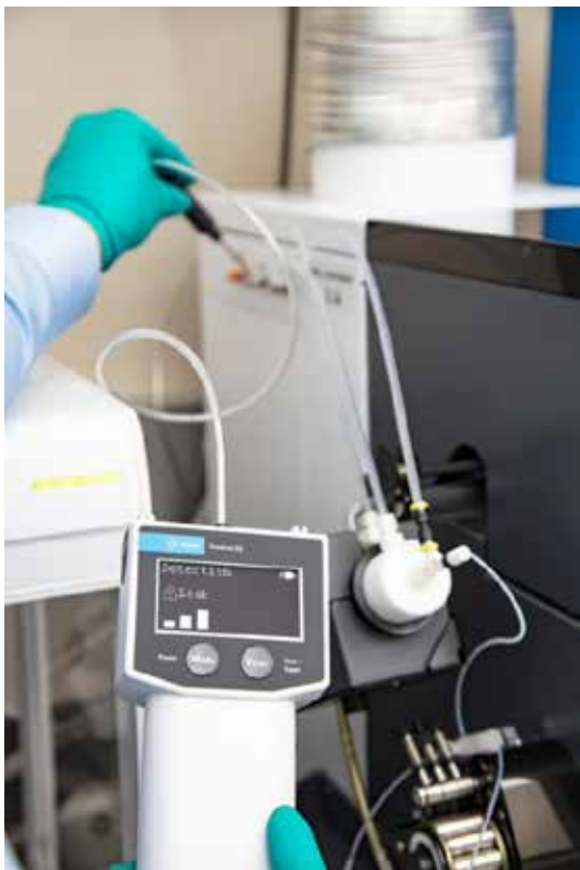
Figura 18. Utilizzo del rivelatore di perdite elettronico Agilent CrossLab CS per verificare la presenza di perdite in corrispondenza dell'apertura per gas opzionale sul sistema ICP-MS Agilent 7900.
