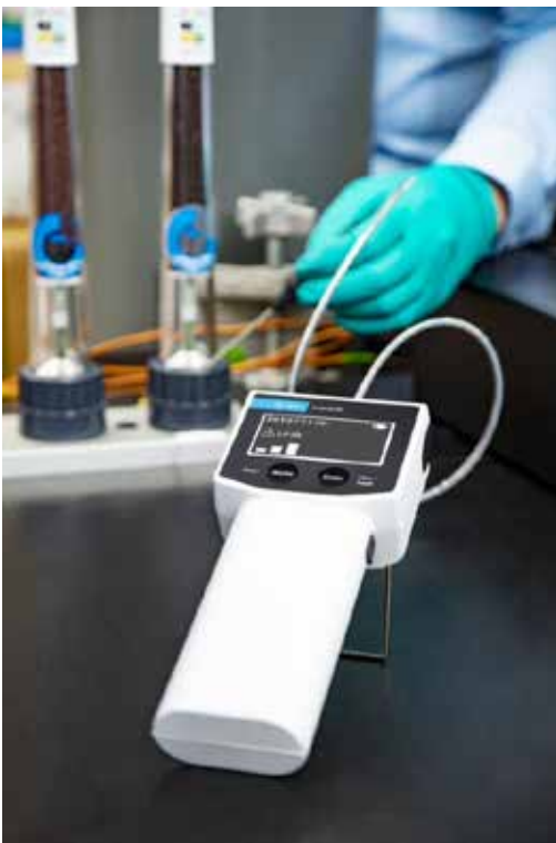
Figura 8. Esempio di verifica della presenza di perdite in un'unità filtro di purificazione gas con il rivelatore di perdite elettronico Agilent CrossLab CS.
