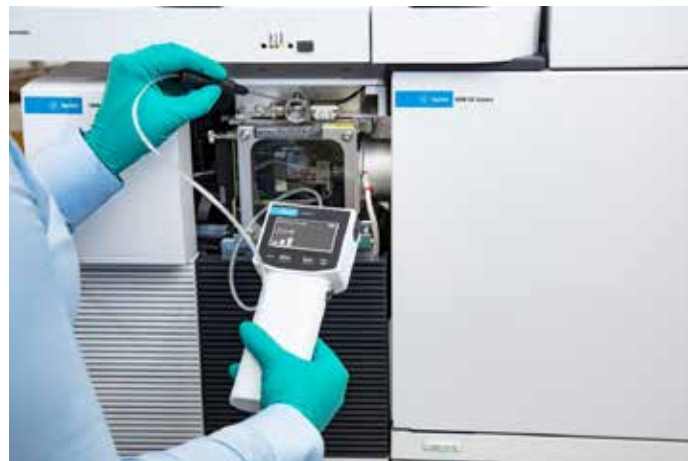
Figura 16. Verifica della presenza di perdite su un sistema GC/MS in corrispondenza della transfer line dello spettrometro di massa nel forno del GC (A) e in corrispondenza della valvola di spurgo (B) sullo spettrometro di massa.
