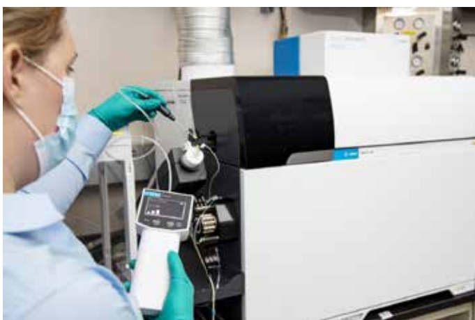
Figura 19. Verifica della presenza di perdite in corrispondenza dei raccordi del nebulizzatore sul sistema ICP-MS Agilent 7900.
