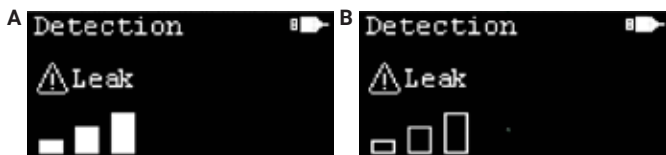
Figure 7. Exemples de fuite de gaz pour des gaz à plus haute conductivité thermique que l'air (A) et fuite de gaz pour des gaz à conductivité thermique plus faible que l'air (B).
