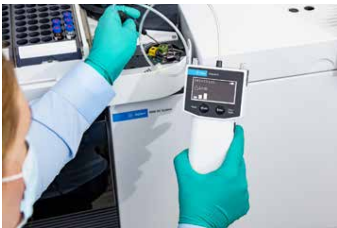
Figure 12. Contrôle d'étanchéité du Septa Agilent du GC avec le détecteur de fuite électronique Agilent CrossLab CS.
