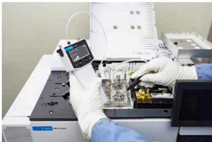
Figure 15. Utilisation d'un détecteur de fuite électronique Agilent CrossLab CS pour vérifier l'étanchéité des raccords dans un système de GC à vannes.
