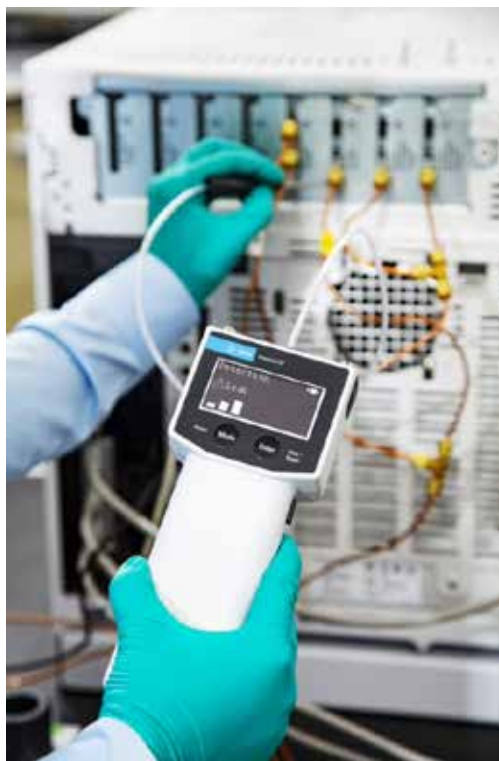
Figure 9. Exemple de contrôle des fuites des raccords à gaz à l'arrière d'un GC 8890 Agilent.
