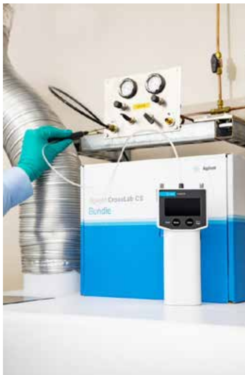
Figure 10. Exemple d'utilisation d'un détecteur de fuite électronique Agilent CrossLab CS pour vérifier les raccords avec de l'argon.
