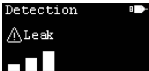
Figure 3. Exemple d'identification de fuite sur l'écran OLED.
