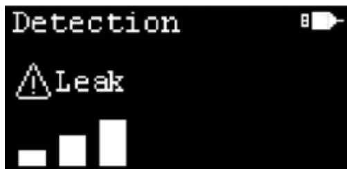
Figura 3. Ejemplo de identificación de una fuga en la pantalla OLED.
