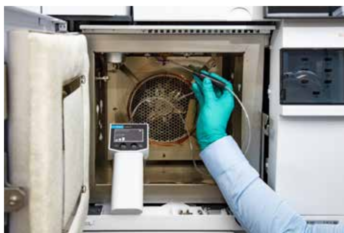
Figura 13. Comprobación de fugas en el inyector de GC (A) y en las conexiones con tecnología de flujo capilar de Agilent (CFT) (B).
