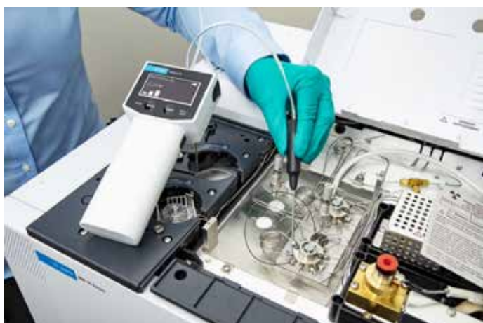
Figura 6. Ejemplo de comprobación de fugas en un sistema de válvula con el detector de fugas electrónico Agilent CrossLab CS.
