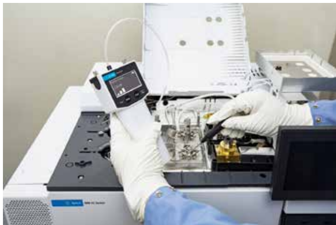
Figura 15. Compruebe si existen fugas con el detector de fugas electrónico Agilent CrossLab CS en las conexiones de un sistema de GC con sistema de válvula.
