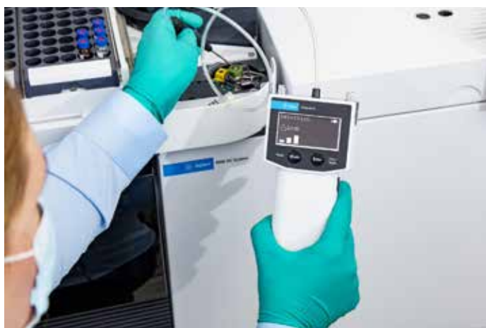
Figura 12. Comprobación de fugas en una tuerca del séptum del inyector de GC con el detector de fugas electrónico Agilent CrossLab CS.
