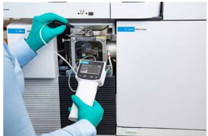
Figura 16. Comprobación de fugas en un sistema de GC/MS en la línea de transferencia del espectrómetro de masas en el horno de GC (A) y en la válvula de venteo (B) del espectrómetro de masas.
