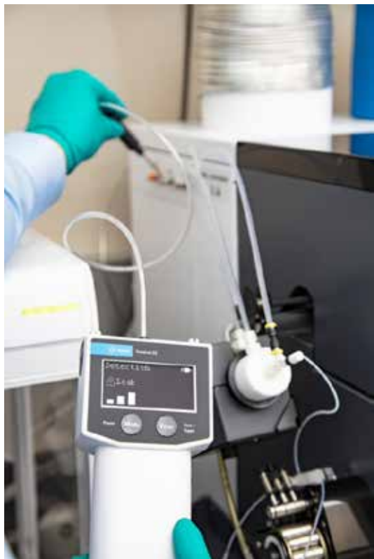
Figura 18. Comprobación de fugas con el detector de fugas electrónico Agilent CrossLab CS en el puerto del gas opcional de un sistema de ICP-MS Agilent 7900.
