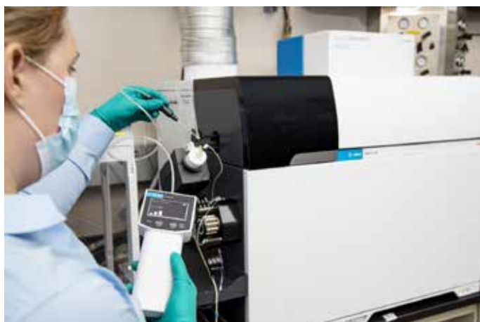
Figura 19. Comprobación de fugas en los conectores del nebulizador de un sistema ICP-MS Agilent 7900.
