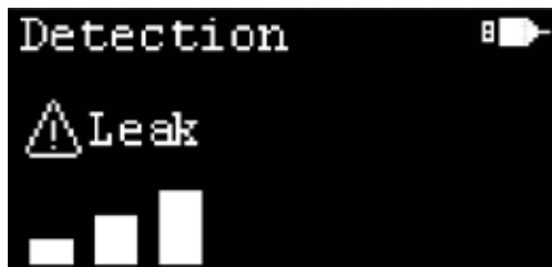
Abbildung 3: Beispielhafte Anzeige auf dem OLED-Bildschirm bei Erkennung einer Undichtigkeit.
