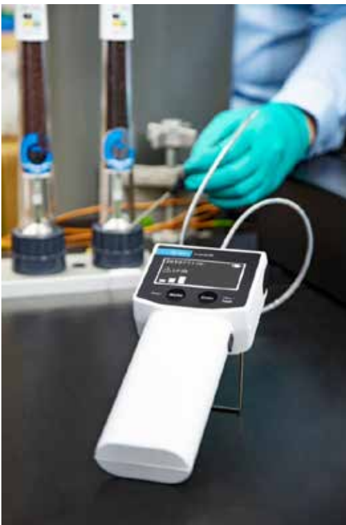
Abbildung 8: Beispiel für die Dichtigkeitsprüfung einer Gas Clean Filter-Einheit mit dem elektronischen Dichtigkeitsprüfgerät des Agilent CrossLab Cartridge Systems.
