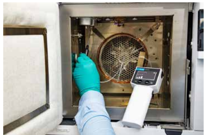
Abbildung 12: Dichtigkeitsprüfung des GC-Einlass-Septums mit dem elektronischen Dichtigkeitsprüfgerät des Agilent CrossLab Cartridge Systems.
