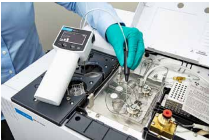
Abbildung 6: Beispiel für die Dichtigkeitsprüfung eines Ventilsystems mit dem elektronischen Dichtigkeitsprüfgerät des Agilent CrossLab Cartridge Systems.
