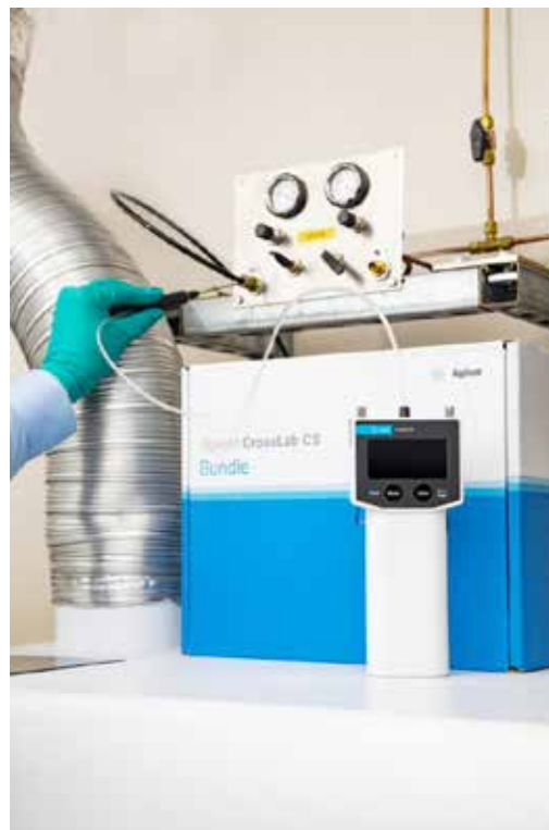
Abbildung 10: Beispiel für eine Prüfung von Argon-Gasfittings mit einem elektronischen Dichtigkeitsprüfgerät des Agilent CrossLab Cartridge Systems
