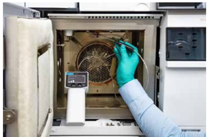
Abbildung 13. Dichtigkeitsprüfung am GC-Einlass (A) und an den Agilent Capillary Flow Technology (CFT)-Anschlüssen (B).
