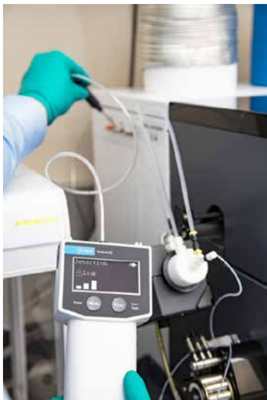
Abbildung 18: Verwendung des Agilent CrossLab CrossLab CS elektronischen Dichtigkeitsprüfgeräts zur Prüfung auf Leckagen am Option-Gas-Anschluss des Agilent 7900 ICP-MS-Systems.
