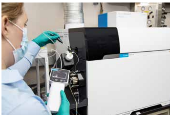
Abbildung 19: Dichtigkeitsprüfung der Zerstäubertittings eines Agilent 7900 ICP-MS-Systems
