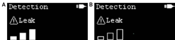
Abbildung 7: Beispiele für Lecks von Gasen, die eine höhere Wärmeleitfähigkeit besitzen als Luft (A) und die eine niedrigere Wärmeleitfähigkeit besitzen als Luft (B).
