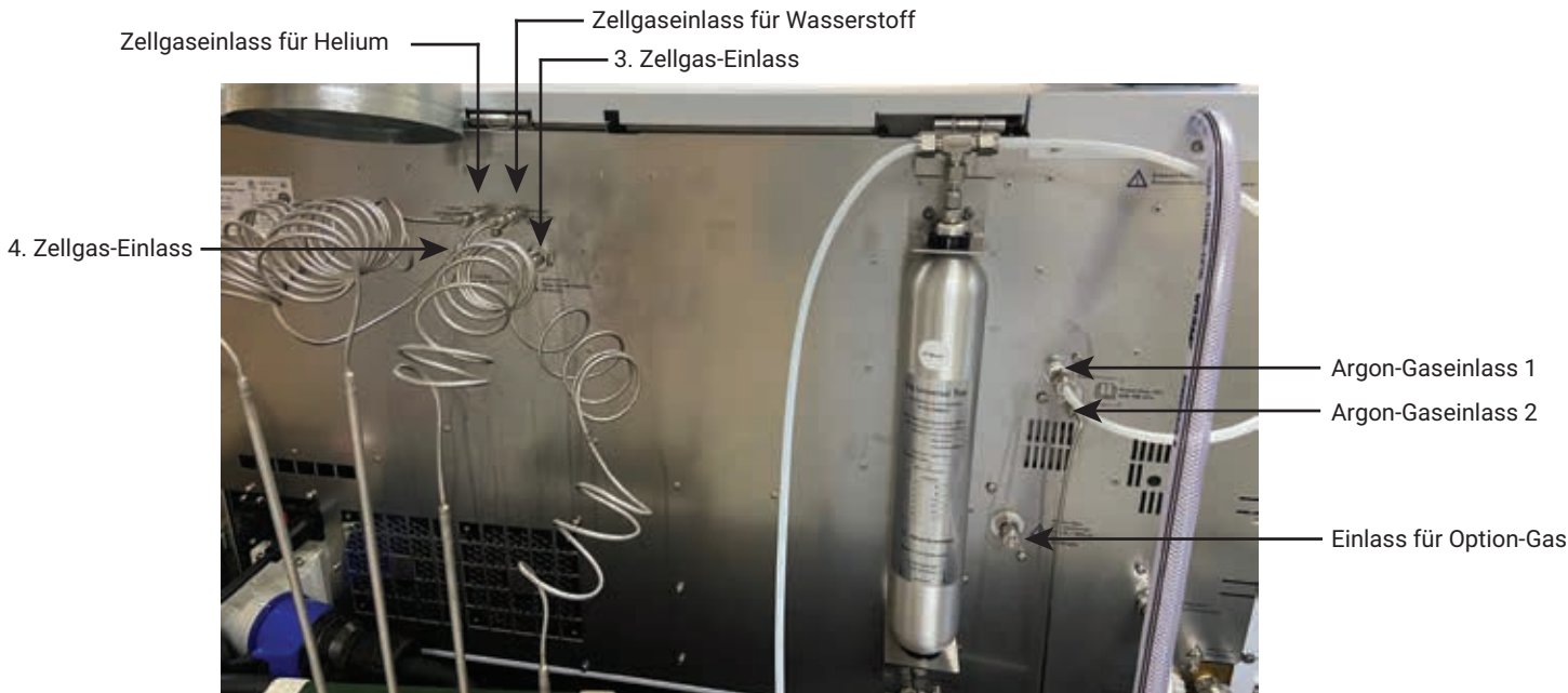
Abbildung 17: Rückansicht eines Agilent ICP-MS-System. Zu erkennen sind die Gaseinlässe, die mit dem elektronisches Dichtigkeitsprüfgerät des Agilent CrossLab Cartridge Systems geprüft werden sollten.
