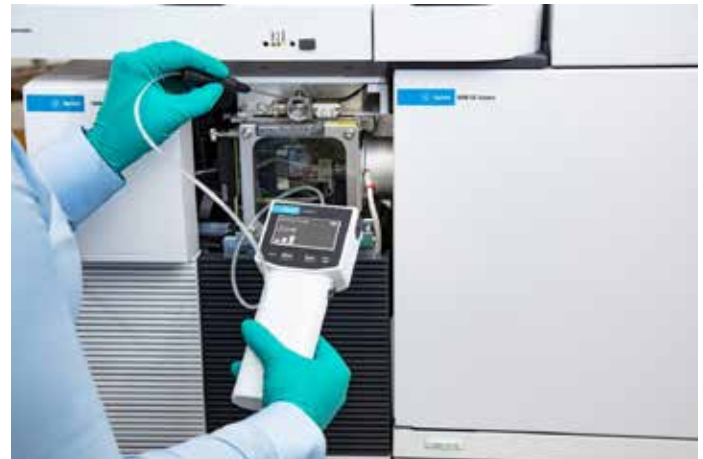
Abbildung 16. Dichtigkeitsprüfung der Massenspektrometer-Übertragungsleitung im GC-Ofen (A) und des Belüftungsventils (B) im Massenspektrometer eines GC/MS-Systems.
