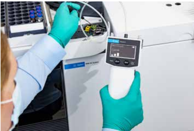
Abbildung 12: Dichtigkeitsprüfung des GC-Einlass-Septums mit dem elektronischen Dichtigkeitsprüfgerät des Agilent CrossLab Cartridge Systems.
