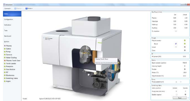
图 14. 查看交互式“仪器状态”页面以检查仪器的当前状态并识别引起问题的原因
