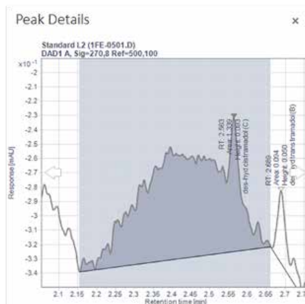
Рис. 8. Окно подробной информации о пике показывает параметры интегрирования выделенного аномального пика. Стрелки вправо и влево позволяют перейти к следующему или предыдущему пика для сравнения.
