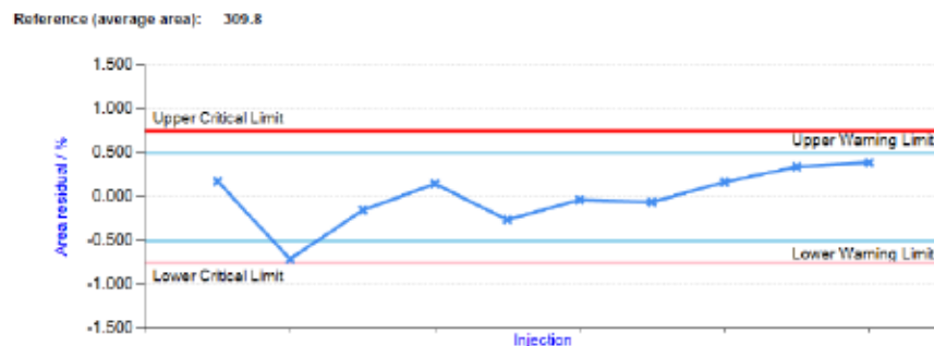
Figura 5. Elabore gráficos de tendência nos sequenciamentos. Aqui, um relatório de sequenciamento cruzado é usado para identificar discrepâncias e limites de controle inferior e superior.
