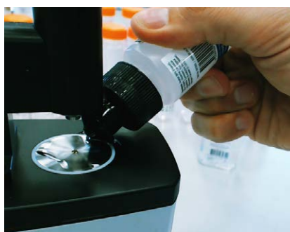
图 8. 将洗手液样品置于 ATR 附件上。Agilent MicroLab 软件通过图片引导式工作流程，帮助用户进行清洁和采样在内的每个测量步骤
