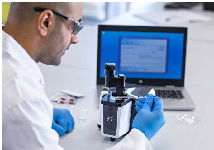
图 1. Agilent Cary 635 FTIR 光谱仪可配备适当的采样附件，以满足所有分析需求。钻石晶体 ATR 采样附件是固体、液体、糊状物和凝胶 FTIR 分析的理想选择
