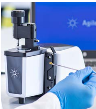
그림 8. Di ATR 모듈을 장착한 Agilent Cary 630 FTIR 분광기를 사용하여 시료 준비 없이 대마초 농축액 및 증류액의 스펙트럼을 기록했습니다.
