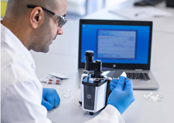
그림 1. Agilent Cary 630 FTIR 분광기에 적합한 샘플링 모듈을 장착하여 분석 요구 사항을 충족할 수 있습니다. 다이아몬드 ATR 샘플링 모듈은 고체, 액체, 젤 및 분말의 FTIR 분석에 이상적입니다.
