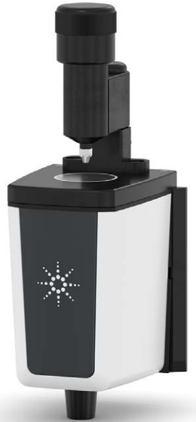
그림 7. Agilent Cary 630 FTIR 분광기용 단일 반사 게르마늄 ATR 모듈.
