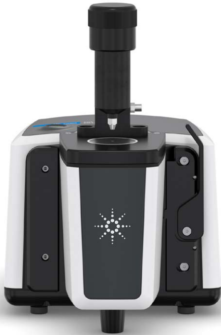
그림 6. Agilent Cary 630 FTIR 분광기용 단일 반사 다이아몬드 ATR 모듈.
