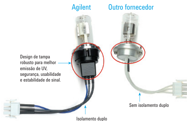
Figura 5. Diferenças no cabo e no design da tampa entre as lâmpadas Agilent e as de outros fornecedores.
