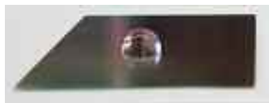
Рис. 3. Капля воды на поверхности из нержавеющей стали с покрытием UltiMetal Plus.
