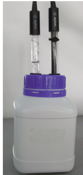
图 1. 实验装置图，pH 电极和参比电极置于密封容器的纯水样品中
