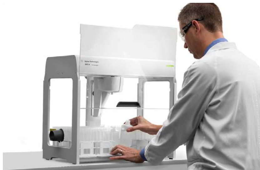
许多自动进样器（例如此处所示的 Agilent SPS 4）都可配备防尘罩，以减少样品暴露于实验室内污染源的可能性。
