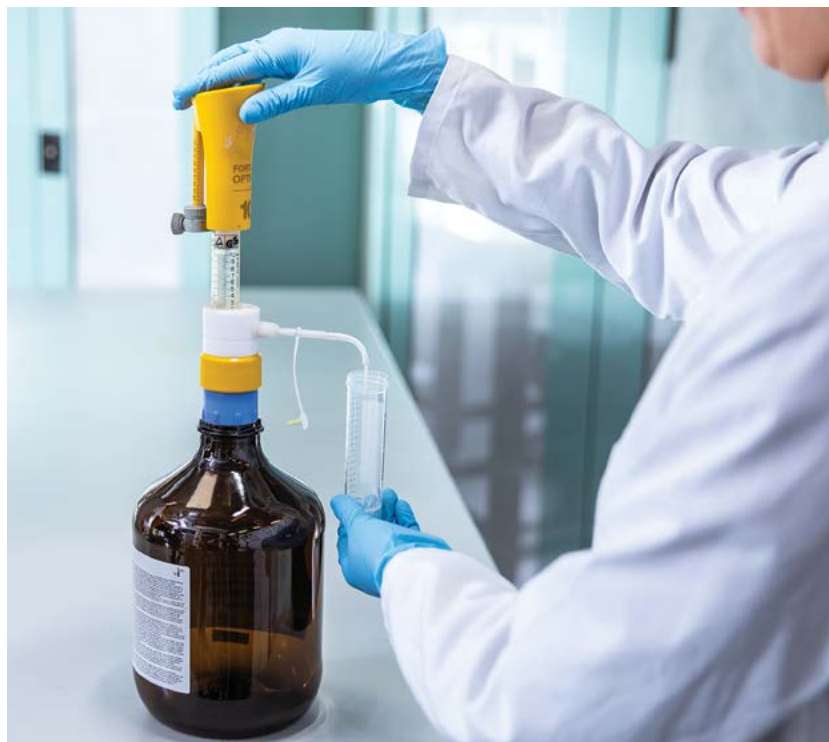
使用酸分液器代替移液器，降低污染风险。
