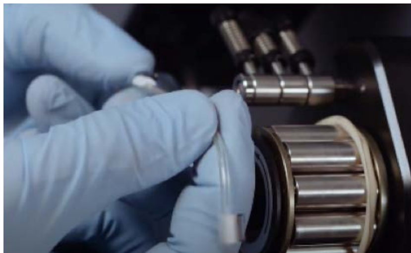
定期检查蠕动泵管的磨损、变色、弹性和圆度，有助于确保将样品平稳、一致地传输到雾化器，而不会产生脉冲。
