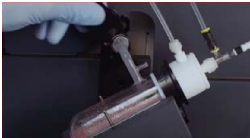
Большое количество капель на внутренних стенках распылительной камеры — признак того, что ее пора чистить.
