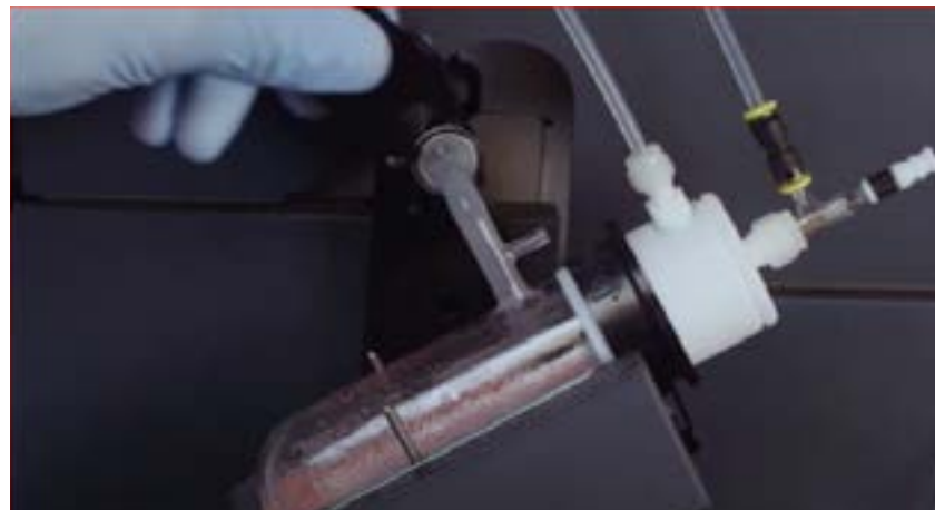
A formação excessiva de gotículas dentro da câmara de nebulização é um dos sinais de que ela precisa de limpeza.
