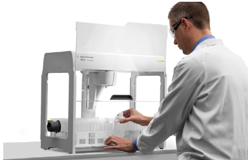
여기에 표시된 Agilent SPS 4와 같은 많은 자동 시료 주입기는 커버가 함께 장착되어 있어 시료가 실험실 내 오염원에 노출되는 것을 줄일 수 있습니다.
