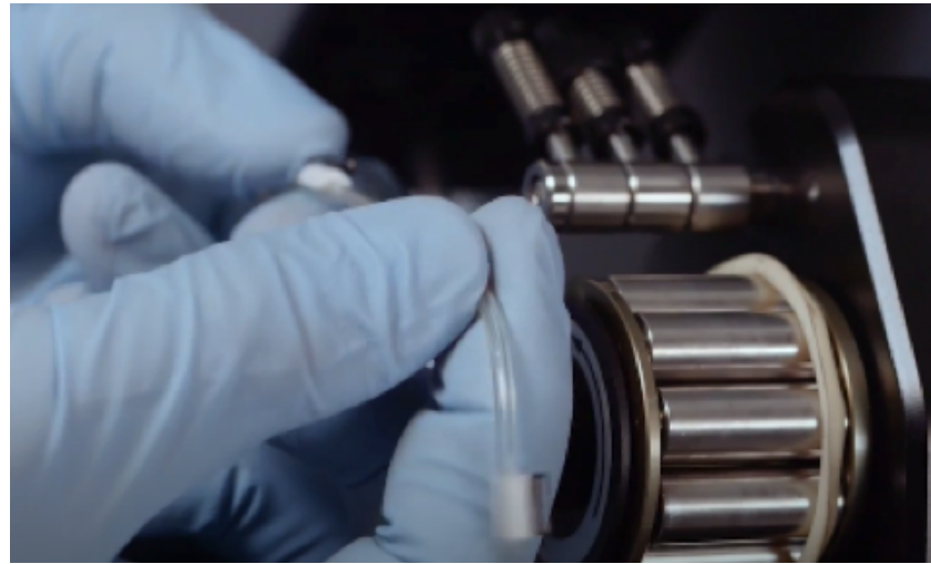
마모, 변색, 유연성 및 견고성 측면에서 연동 펌프 튜브를 정기적으로 점검하면 펄스 효과 없이 일관된 양의 시료가 nebulizer에 원활하게 공급되도록 하는 데 도움을 줄 수 있습니다.
