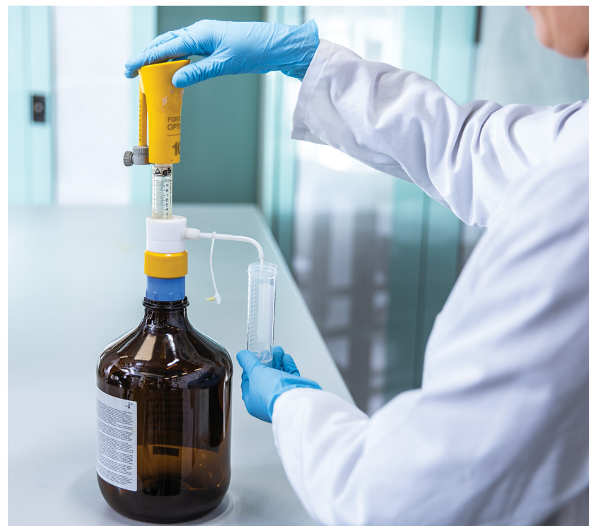
汚染リスクを下げるために、ピペットではなく酸用のディスペンサを使用します。
