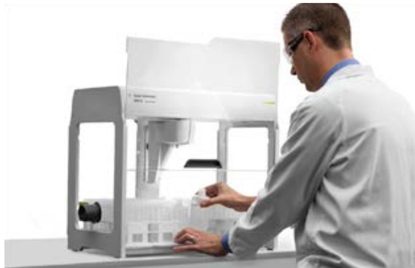
Molti autocampionatori, come il modello Agilent SPS 4 dell'immagine, possono essere dotati di involucri per ridurre l'esposizione dei campioni a fonti di contaminazione nel laboratorio.
