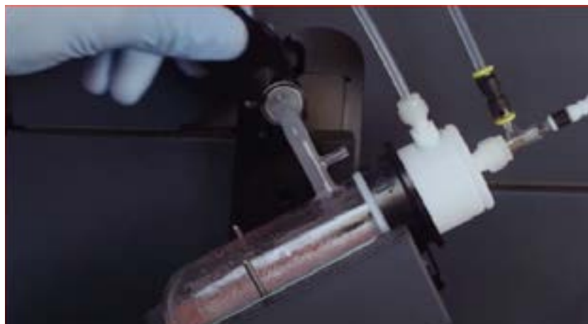
Una formazione eccessiva di goccioline all'interno della camera di nebulizzazione è uno dei segnali che indicano la necessità di procedere alla pulizia della camera di nebulizzazione.
