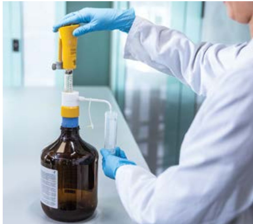
Utilisez un distributeur d'acide plutôt que des pipettes pour réduire le risque de contamination.
