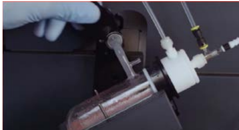
Une formation excessive de gouttelettes à l'intérieur de la chambre de nébulisation indique que la chambre de nébulisation doit être nettoyée.
