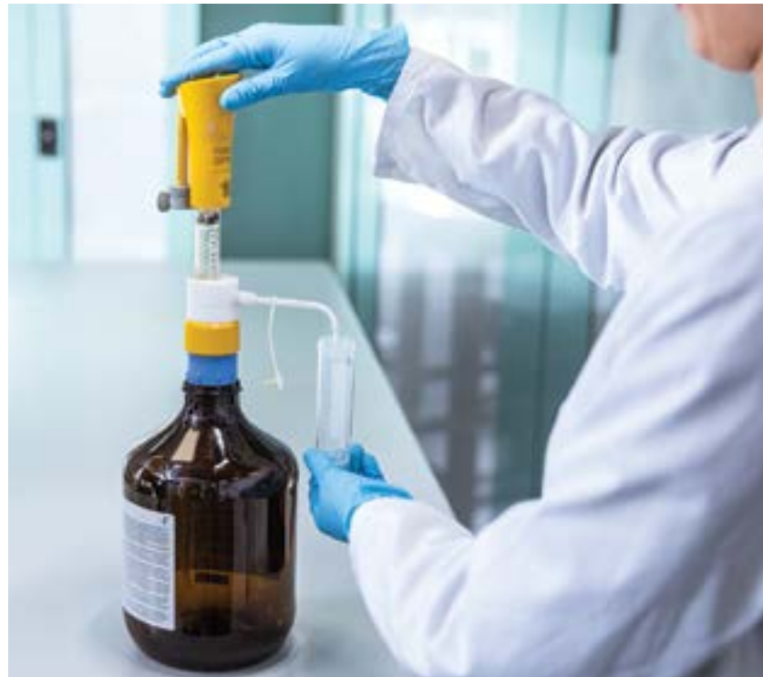
Utilice un dispensador de ácido en lugar de pipetas para reducir el riesgo de contaminación.
