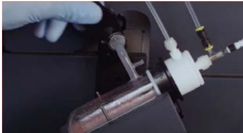
La formación de una cantidad excesiva de gotas dentro de la cámara de nebulización es una de las señales que indica que hay que limpiar dicha cámara.
