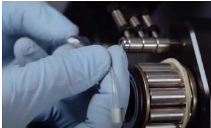
Regelmäßige Überprüfungen des Schlauchs der peristaltischen Pumpe auf Abnutzung, Verfärbung, Flexibilität und runde Form tragen dazu bei, dass die Probe problemlos, konsistent und ohne Pulsation zum Zerstäuber geleitet wird.
