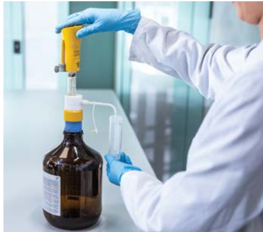
Verwenden Sie Flaschenaufsatzdispenser anstelle von Pipetten, um die Kontaminationsgefahr zu verringern.
