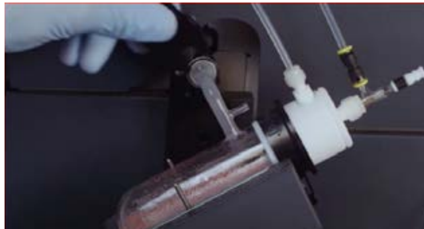
Eine übermäßige Bildung von Tröpfchen in der Zerstäuberkammer ist ein Zeichen dafür, dass die Zerstäuberkammer gereinigt werden muss.
