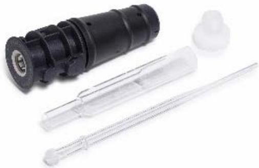
图 3. 在分析富含锂的基质时使用完全可拆卸式炬管。这样可以只更换被锂损坏的部件，更加方便
