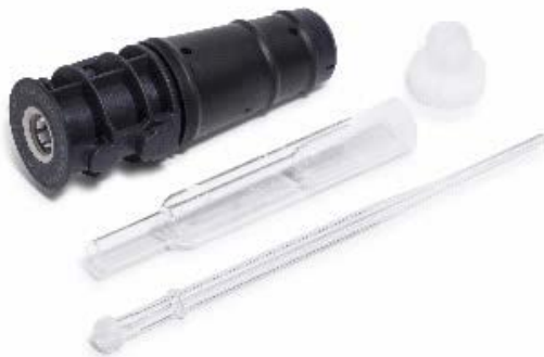
그림 3. 리튬이 풍부한 매트릭스를 분석할 경우 완전 분리형 토치를 사용하세요. 이를 통해 리튬에 의해 손상된 구성 요소만 쉽게 교체할 수 있습니다.
