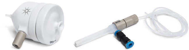
그림 4. 애질런트 비활성 스프레이 챔버 및 OneNeb Nebulizer는 HF로 분해된 시료 분석에 이상적입니다.
