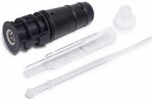
Figura 3. Usare una torcia completamente smontabile per l'analisi di matrici ricche di litio. In questo modo è più facile sostituire solamente i componenti danneggiati dal litio.
