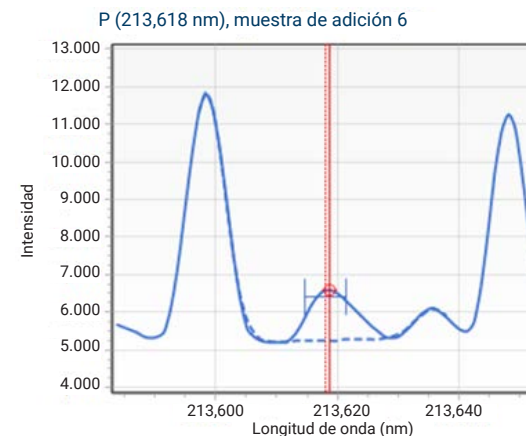
Figura 2. Espectro de P a 213,618 nm en el material del cátodo de la batería, con aplicación de la corrección de fondos ajustada, que garantiza una corrección precisa con el complejo fondo en pendiente
