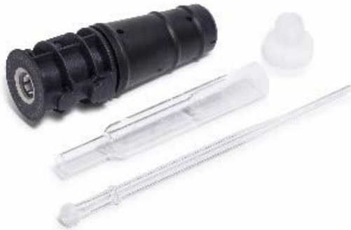
Abbildung 3. Verwenden Sie eine vollständig zerlegbare Fackel, wenn Sie lithiumreiche Matrices analysieren. Sie ermöglicht es, nur die Komponenten auszutauschen, die durch das Lithium beschädigt wurden.
