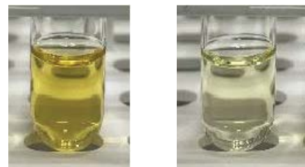
图 2. 烟草萃取物：未净化（左图），经过 Agilent Captiva EMR-LPD 净化（右图）
