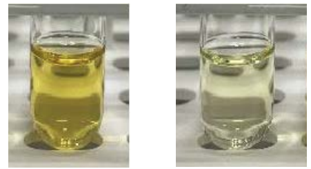
Figura 2. Extracto de tabaco: sin limpieza (izquierda), después de limpieza con Agilent Captiva EMR-LPD (derecha).
