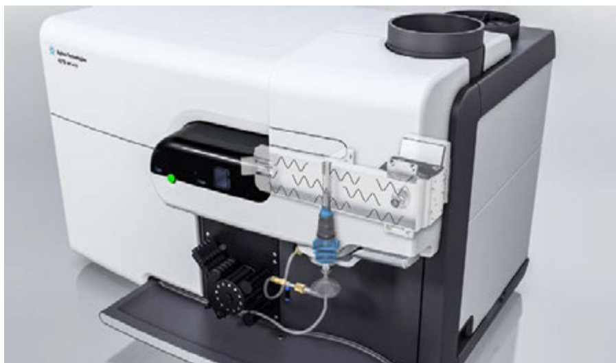
Figura 2. La guía de microondas genera campos electromagnéticos concentrados alrededor de la antorcha.
