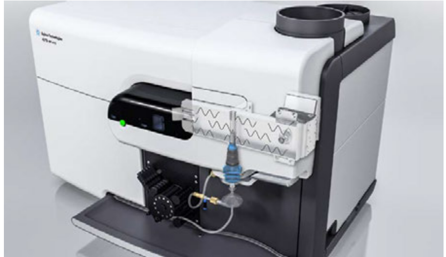
Figura 2. Um guia de ondas induzido por micro-ondas cria campos eletromagnéticos ao redor da tocha.
