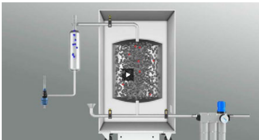
Figure 1. Le générateur d'azote extrait l'azote de l'air comprimé pour alimenter le plasma.
