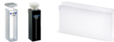
Figura 15. Cuvette per la misura di campioni in soluzione. Da sinistra a destra: Cuvetta standard da 3 mL con lunghezza del percorso di 10 mm, cella ultra-micro per la misura di volumi molto piccoli e cuvetta con lunghezza del percorso maggiore per soluzioni diluite.
