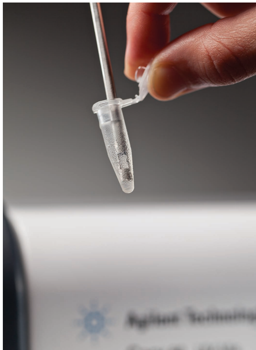
Figura 6. Una sonda a fibra ottica può essere montata come accessorio su uno spettrofotometro UV-Vis per misurare campioni in soluzione in diversi tipi di contenitori.
