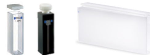
Figure 15. Cuves de mesure pour échantillons liquides. De gauche à droite : cuve standard de 3 mL et trajet optique de 10 mm, cellule ultra-micro pour mesurer les très faibles volumes et cuve à long trajet optique pour les solutions diluées.
