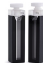
Figure 20. Cellule semi-micro de 1,4 mL et 10 mm de trajet optique.
