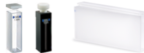
Figura 15. Cubetas para medir muestras líquidas. De izquierda a derecha: Una cubeta estándar de 3 ml con una longitud del camino óptico de 10 mm; una celda ultramicro para medir volúmenes muy bajos y una cubeta con trayecto óptico largo para soluciones diluidas.
