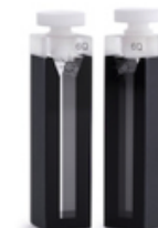
Figura 20. Celda semimicro de 1,4 ml de volumen con una longitud del camino óptico de 10 mm.
