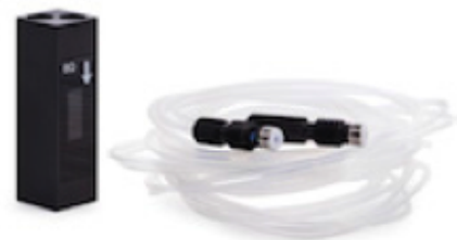
Figura 21. Celda de flujo con aberturas rectangulares de 4 x 11 mm y una longitud del camino óptico de 10 mm. En la imagen aparecen los conectores y el tubo.
