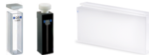
Abb. 15: Küvetten für die Messung von flüssigen Proben. Von links nach rechts: Standard-Küvette mit einer Schichtdicke von 10 mm und einem Volumen von 3 ml, Ultramikroküvette für sehr niedrige Volumen und eine Küvette mit sehr großer Schichtdicke für verdünnte Lösungen.
