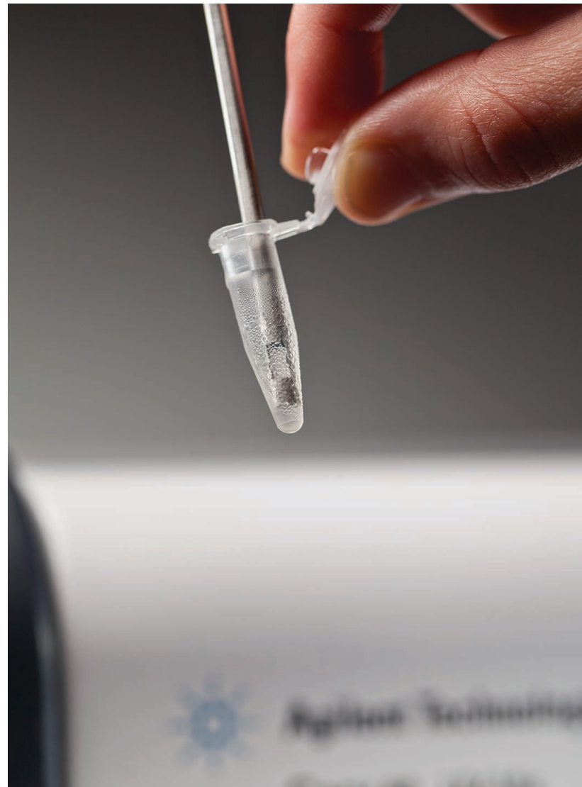
Abb. 6: Ein UV-Vis-Spektralphotometer kann mit einer Faseroptik-Sonde ausgestattet werden, um Flüssigproben in verschiedenen Behältern zu messen.
