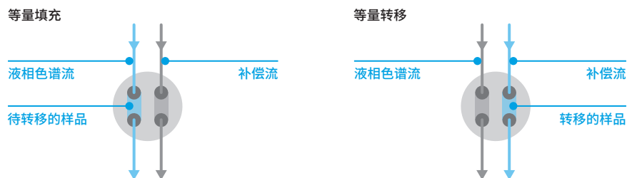
图 30. 主动式分流器的示意图，显示了阀的填充和转移位置
