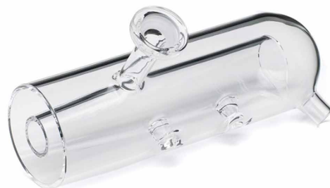
エアロゾルはスプレーチャンバを通過するが、ここで大きめの液滴が除去されます。
