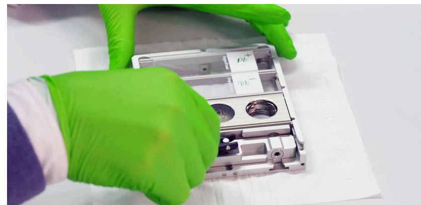
レーザーアブレーションのサンプルホルダーに固体サンプルをロードします。ここでは顕微鏡スライドに生体サンプルをロードしています。
