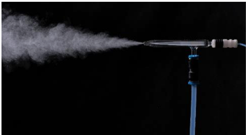
图 12. 样品通常以液体形式引入，以使用任何原子光谱技术进行测量。除 GFAAS 以外，所有技术均使用雾化器将液体样品转变为气溶胶雾。GFAAS 使用进样针进样液体样品
