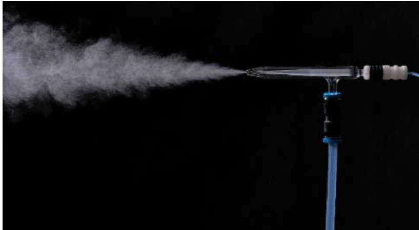
그림 12. 시료는 일반적으로 원자 분광 기법을 사용한 측정을 위해 액체 형태로 주입됩니다. GFAAS를 제외한 모든 기법은 nebulizer를 사용하여 액체 시료를 에어로졸 미스트로 변환합니다. GFAAS는 시린지를 사용하여 액체 시료를 주입합니다.
