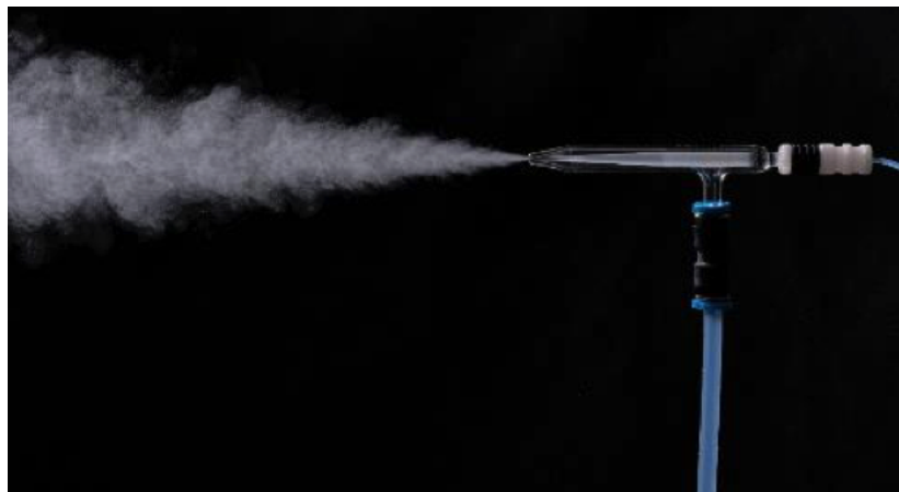
図 12. 何らかの原子分光分析技法を使用してサンプル測定を行うためには、サンプルは通常液体の形で導入されます。GFAAS を除くすべての技法では、ネブライザを使用して液体サンプルをエアロゾルにします。GFAAS では、シリンジを使用して液体サンプルを注入します。
