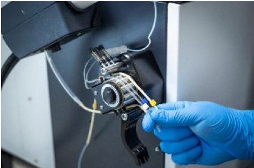
Figura 15. I tubi della pompa devono essere compatibili con il solvente in uso.
