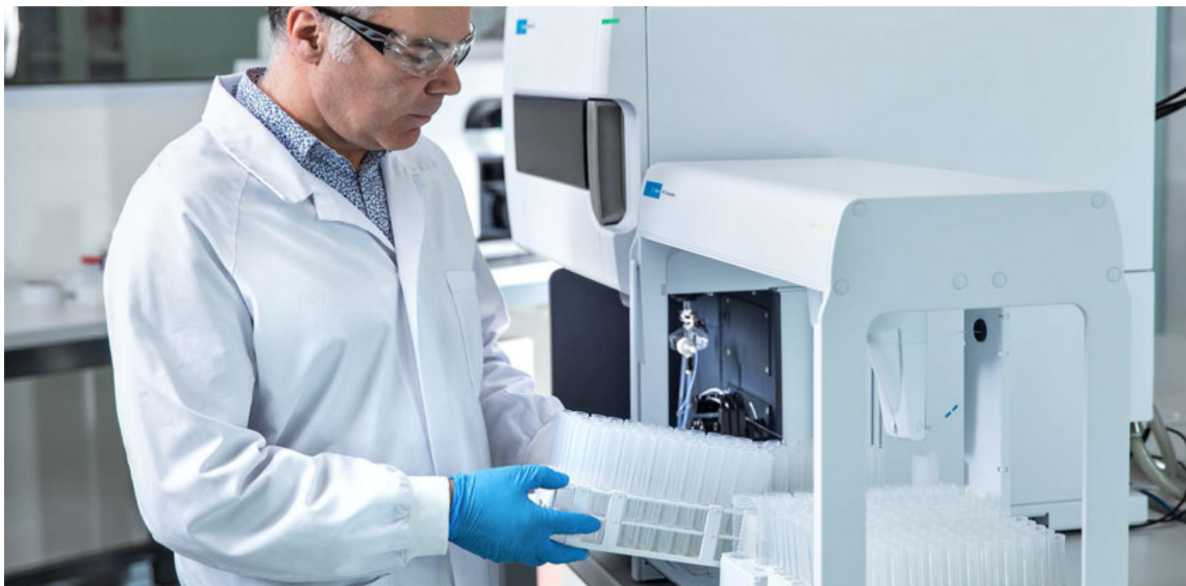
Figure 9. L'utilisation d'un passeur automatique d'échantillons permet d'augmenter la productivité et de faire fonctionner l'instrument sans surveillance.
