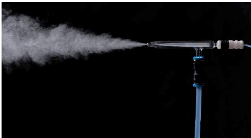
Figura 12. Las muestras suelen introducirse en forma líquida para la medida utilizando cualquier técnica de espectroscopia atómica. Todas las técnicas, salvo la GFAAS, utilizan un nebulizador para convertir la muestra líquida en un vapor de aerosol. En GFAAS se inyecta la muestra líquida utilizando una jeringa.
